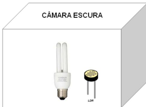
O *setup* experimental é constituído por uma câmara escura (feita a partir de uma caixa de cartão suficientemente grande) a lâmpada a testar e um luxímetro construído em torno de um LDR. Algumas das características do LDR encontram-se no documento em anexo.
