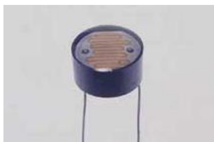
Fig. 19. Aspecto de um LDR comercial.
