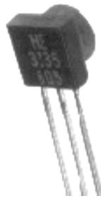
Fig. 40. Aspecto de um sensor de efeito Hall. comercial
